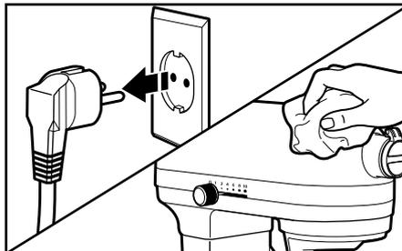
**1** Immer den Netzstecker ziehen, ehe mit den Reinigungsarbeiten begonnen wird. Die Küchenmaschine mit einem feuchten weichen Tuch abwischen. Verwenden Sie keine kommerziellen oder Haushaltsreiniger. Die Rührerwelle regelmäßig abwischen und dort angesammelte Nahrungsmittelreste beseitigen. Nicht ins Wasser tauchen.
