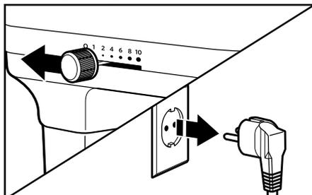
**1** Draai de snelheidsregelaar op "0" (UIT) en trek de stekker uit het stopcontact.
