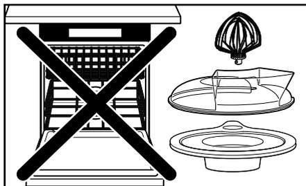
**3** **WICHTIG: Schneebesens, Spritzschutz mit Einfüllschütte und Deckel sind nicht spülmaschinengeeignet.** Sie können mit heißem Seifenwasser gereinigt und vor dem Abtrocknen gründlich abgespült werden. Schneebesens nicht auf der Welle lagern.
