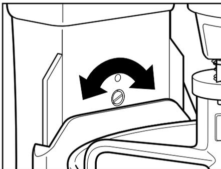
**3** Draai de bijstellingsschroef voor de hoogteafstelling van de kom iets tegen de klok in (naar links) om de platte menghaak omhoog te brengen, of met de klok mee (naar rechts) om de platte menghaak te laten zakken. Stel de platte menghaak zodanig af dat deze de bodem van de kom net niet raakt. Als u de schroef te ver draait kan het gebeuren dat de komlifthendel niet op zijn plaats vergrendelt.
