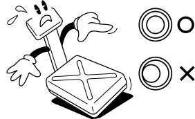
Eloignez la balance d'autres appareils électromagnétiques. Cela risquerait d'altérer la précision des relevés.
