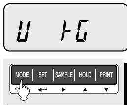
① Appuyer sur MODE. La balance passe en mode changement d'unité et l'affichage indique "U kg".
