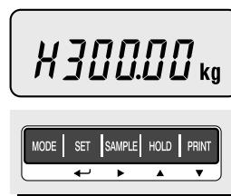
④ Appuyer sur HOLD (▲) ou PRINT (▼) pour augmenter ou baisser le chiffre. Pour entrer le chiffre suivant, appuyer sur SAMPLE (►).
