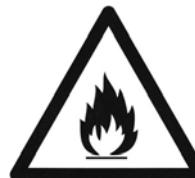
Das Gerät enthält das umweltfreundliche, jedoch brennbare Kältemittel Isobutan (R600a). Daher ist darauf zu achten, dass das Kältesystem beim Transport und auch nach Aufstellung des Gerätes geschützt wird. Bei Beschädigung des Systems darf das Gerät nicht in Betrieb genommen werden. Offenes Feuer oder Zündquellen in der Nähe des Kältemittels entfernen und den Raum gut lüften.
