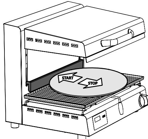
**Bei Stromausfall während des Kochvorgangs wird nach wiederhergestellter Stromversorgung die verbleibende Kochzeit zum Zeitpunkt des Zwischenfalls durch Blinken des Displays angezeigt. Durch Drücken der Taste "START" nimmt das Gerät den Kochvorgang mit diesen Angaben wieder auf.**
