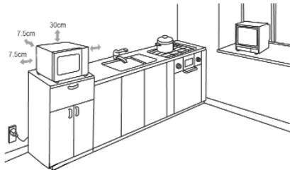
Das Gerät darf nicht in einem Schrank eingebaut werden. Die Montage des Gerätes direkt unter einer Platte oder einem Schrank ist nicht erlaubt.
