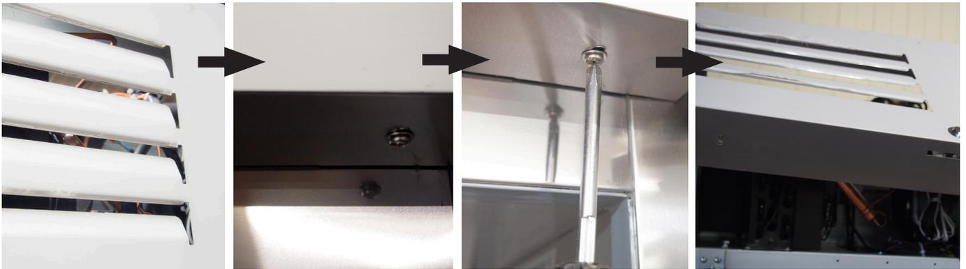
Schrauben Sie das Lüftungsgitter mit einem Kreuzschraubenzieher ab. Beachten Sie, dass an beiden Seiten eine Verschraubung zu finden ist. Klappen Sie die Lüftungsklappe nach oben hin auf.
